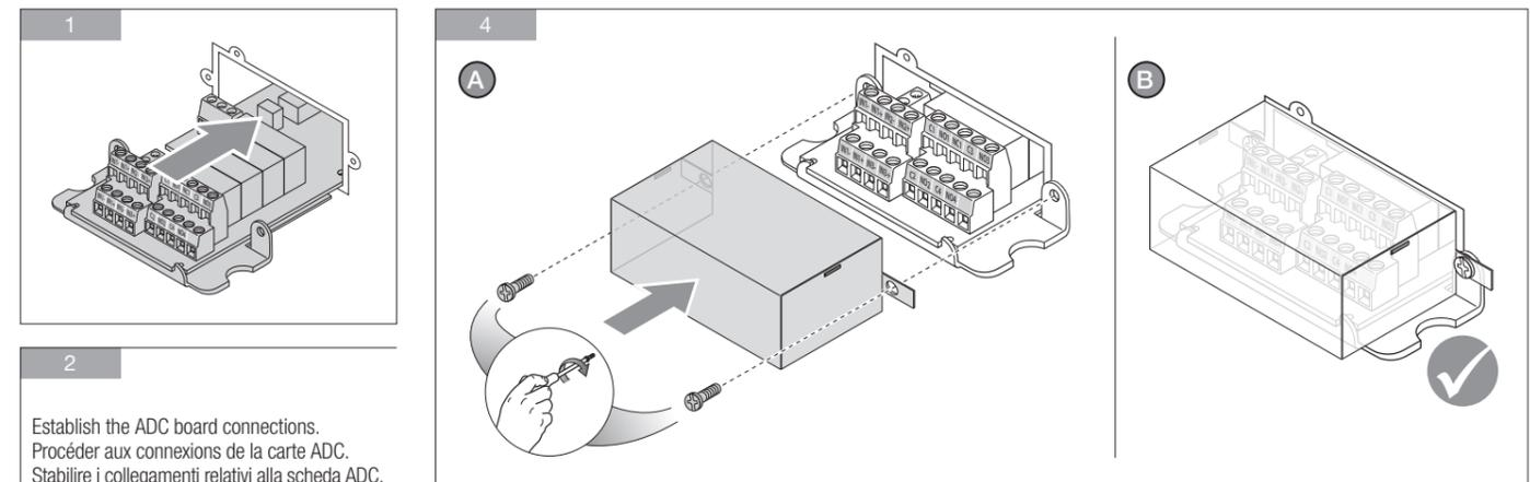
Establish the ADC board connections. Procéder aux connexions de la carte ADC. Stabilire i collegamenti relativi alla scheda ADC. Stellen Sie die ADC-Platinenanschlüsse her. Establecer las conexiones de la tarjeta ADC.
